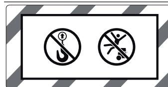
搬運時，請勿將吸塵器掛在起重機的掛鉤上。吸塵器不可用起重機吊運。可能會造成人員受傷或物品損壞。
