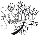
Тонкие ветви легко могут застрять между звеньями цепи и поранить оператора, будьте предельно осторожны при обрезке мелкого кустарника и тонких ветвей деревьев.
