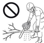
Не работайте цепной пилой, держа ее одной рукой. Последствиями работы одной рукой могут стать серьезные травмы оператора, помощников или окружающих. Для должного контроля всегда работайте цепной пилой обеими руками, одна из которых управляет выключателем. В противном случае пила может выскоcить из рук, или ее может увести в сторону, что приведет к серьезным травмам из-за потери контроля над ней.
